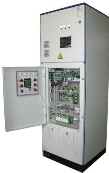
Комплектный преобразователь типа ПАД-В-К-125-6к-1 УХЛ для индивидуального плавного пуска асинхронного двигателя номинальной мощностью 1000 кВт и напряжением 6 кВ
